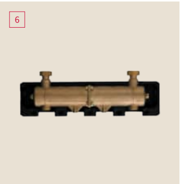
Bouteille de découplage hydraulique pour PAC Cet accessoire sépare hydrauliquement le réseau des émetteurs et de la chaudière de celui de la PAC. ATW-HSK-01
