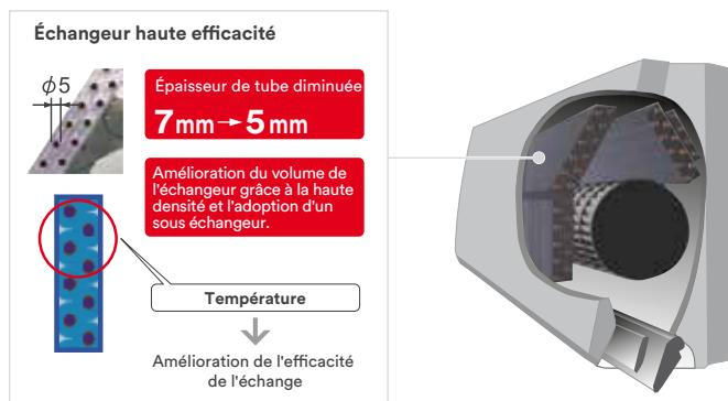
Cette gamme propose un flux d'air puissant grâce au large diffuseur, à la turbine tangentielle ainsi qu'à la conception de l'appareil.
