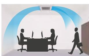
Diffusion d'air optimisée en évitant le soufflage direct d'air froid et en fournissant des flux d'air oscillant en même temps.
