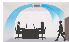
Diffusion d'air optimisée en évitant le soufflage direct d'air froid et en fournissant des flux d'air oscillant en même temps.
