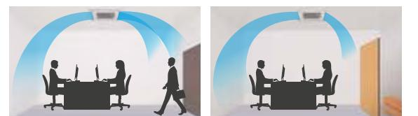
Diffusion d'air optimisée en évitant le soufflage direct d'air froid et en fournissant des flux d'air oscillant en même temps.
